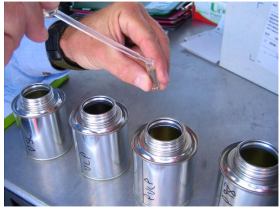
Abbildung 1. Die Proben werden in Einweggefäße mit einer Pfadlänge von 8 mm gefüllt.
