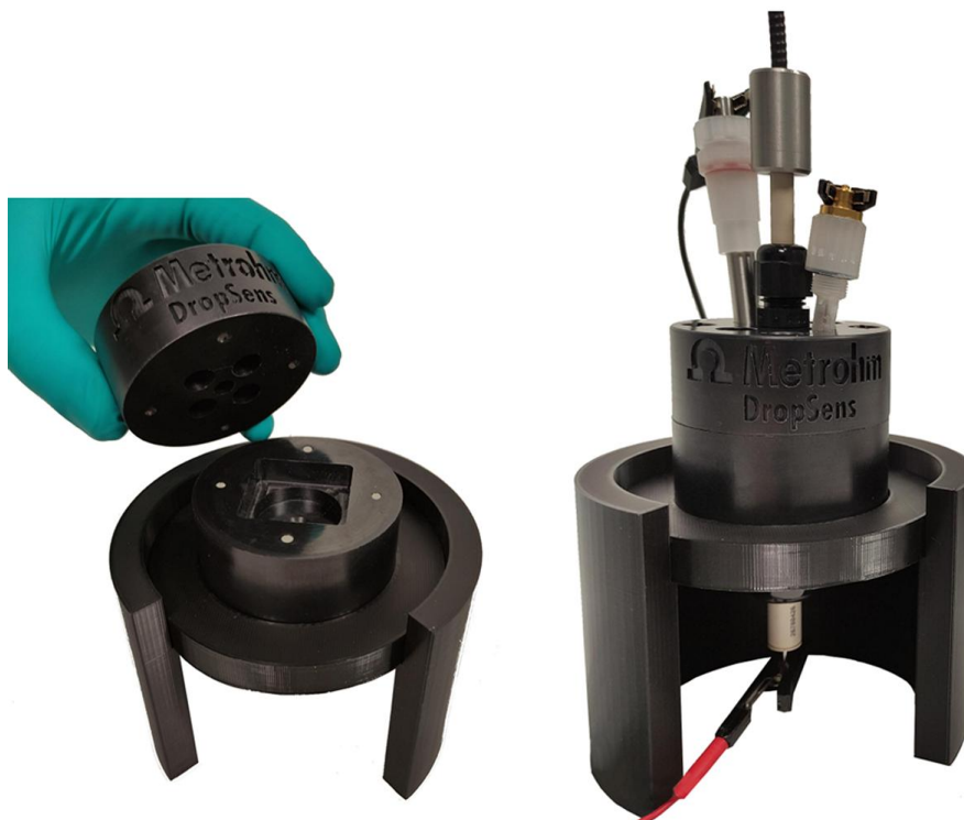
Abbildung 1. REFLECELL-C, die UV-Vis-Zelle für konventionelle Elektroden. Innenansicht (L) und komplett montierte Zelle mit WE, CE, RE und Lichtleiter, gehalten mit einem Klemmstück für eine optimale Positionierung (R).
