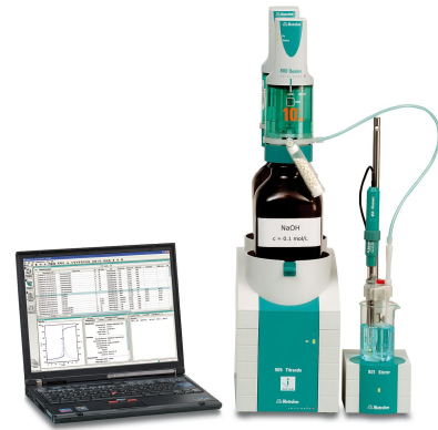
Abbildung 1. 905 Titrando mit tiemo. Beispielaufbau für die Titerbestimmung von Salzsäure.
