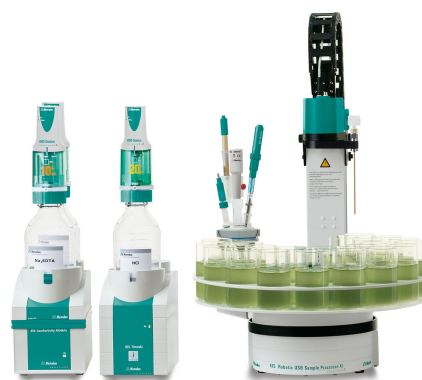
Abbildung 1. Beispielaufbau eines 815 Robotic USB Sample Processor XL mit einem externen Titriergefäß, einem 905 Titrando und einem 856 Conductivity Module mit iAquatrode plus, kombinierter Ca-ISE, iAg-Titrode und 5-Ring-Leitfähigkeitsmesszelle für die Analyse von Leitungswasser.
