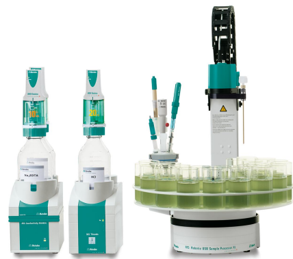
Abbildung 1. Beispielaufbau eines 815 Robotic USB Sample Processor XL mit einem externen Titriergefäß, einem 905 Titrand und einem 856 Conductivity Module mit iAquatrode plus, kombinierter Ca-ISE, iAg-Titrode und 5-Ring-Leitfähigkeitsmesszelle für die Analyse von Leitungswasser.
