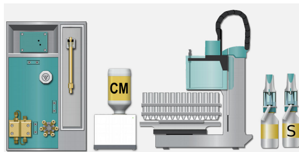
Abbildung 1. Aufbau für Trinkwasseruntersuchungen mit einem 930 Compact IC Flex mit automatischer KOH-Eluentenherstellung (948 Continuous IC Module, CEP), einem 858 Professional Sample Processor und der intelligenten Partial-Loop-Injektionstechnik (MiPT) von Metrohm.
