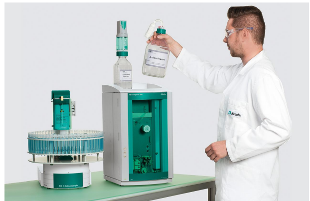
Abbildung 1. Kompakte, benutzerfreundliche Metrohm IC-Geräte zur Quantifizierung verschiedener Anionen in Sprengstoffen und Explosionsrückständen.
