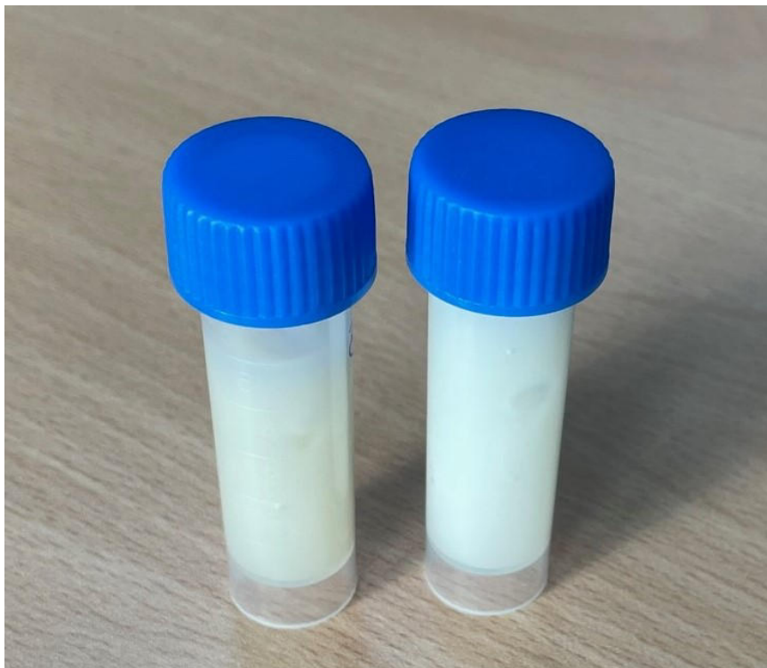
Abbildung 2. Kalt extrahiertes Fett aus gemahlenden Würsten. Der Petrolether wurde bei 15 mbar und Raumtemperatur entfernt.
