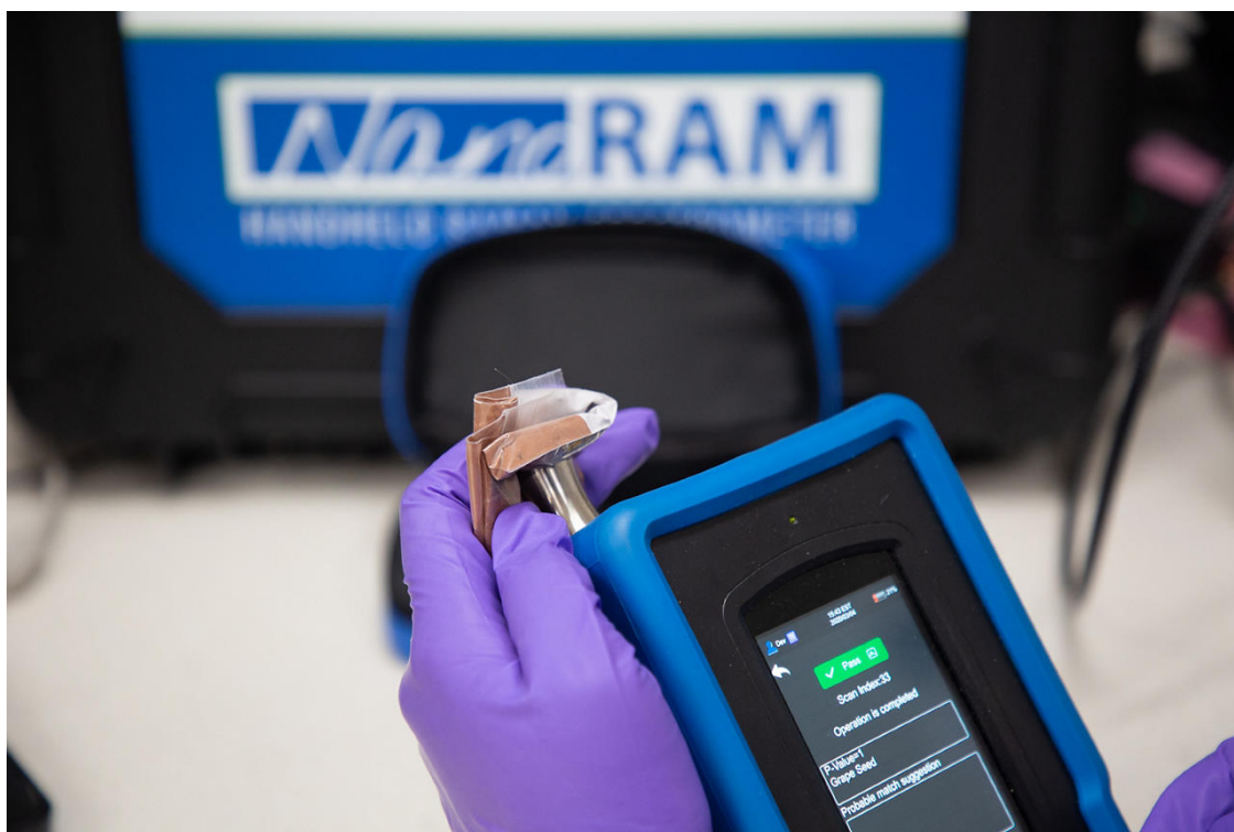
Abbildung 2 Analyse von Traubenkernextrakt mit einem 1064-nm-Laser mit Point-and-Shoot-Adapter.
