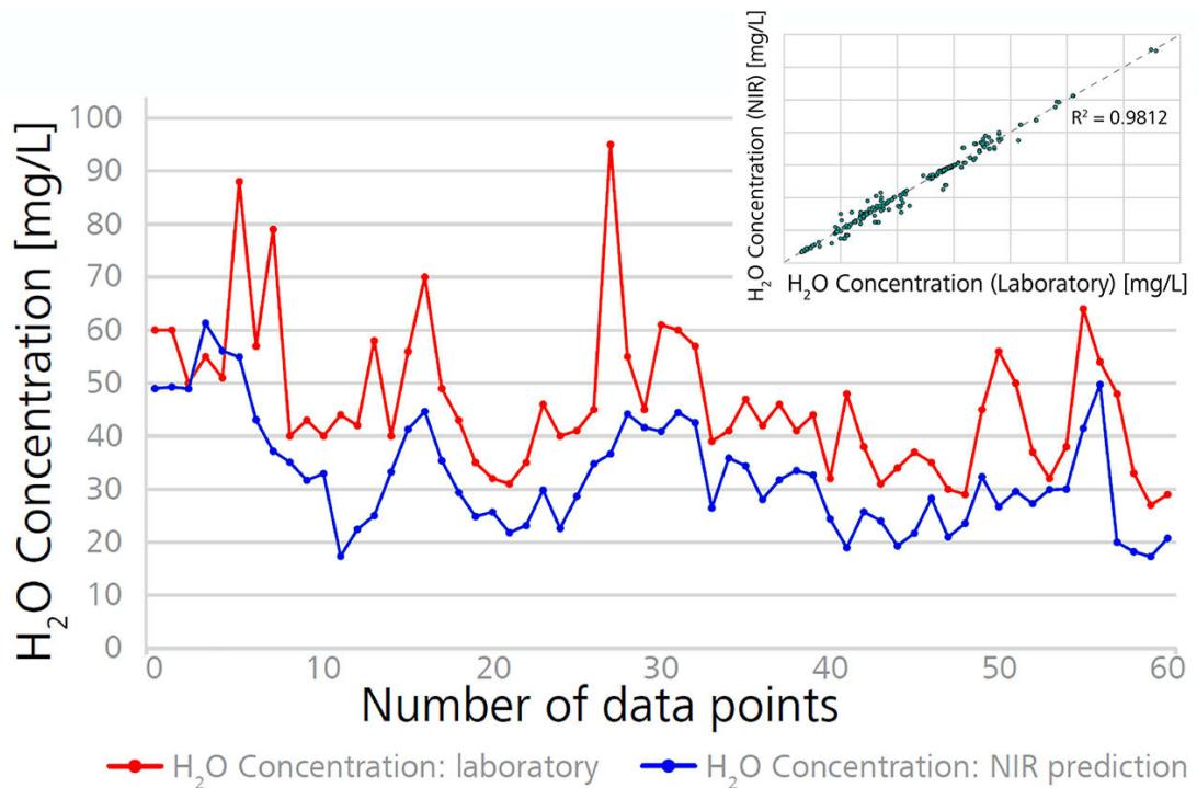
**Abbildung 1.** (a) 2060 The NIR Analyzer Konfiguration mit Durchflusszellen für die Online-Analyse des Wassergehalts in PO-Strömen. (b) Validierung der NIR-Prozessdaten durch Karl-Fischer-Titration (KF) im Labor und das daraus erstellte NIR-Kalibriermodell zur Vorhersage der Wasserkonzentration in Propylenoxid-Prozessströmen. Alle Abbildungen wurden dem Artikel [2] der GIT Labor-Fachzeitschrift entnommen.
