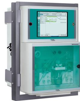
Abbildung 3. 2035 Process Analyzer.
