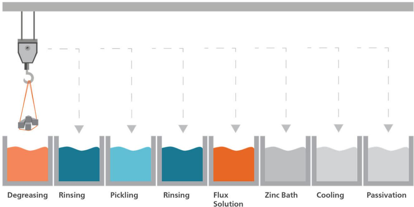
**Abbildung 1.** Illustration des mehrstufigen Feuerverzinkungsprozesses. Das Beizbad (Pickling Bath) ist in hellblau dargestellt.
