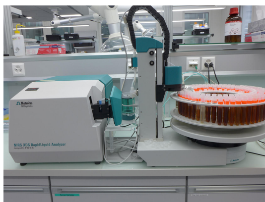
Abbildung 1. XDS RapidLiquid Analyzer mit 5,0 mm Durchflusszelle und dem 815 Sample Processor.
