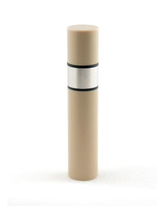
Abbildung 1 Rotierende Zylinderelektrode mit Metalleinsatz, O-Ringe aus Viton (schwarz) und PEEK-Halter.
