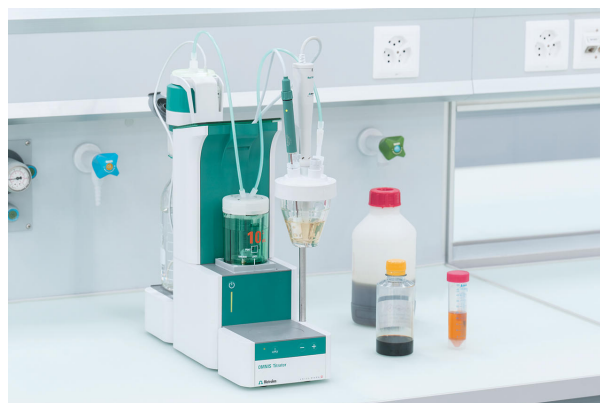
Abbildung 1. OMNIS Titrator-Setup für die thermometrische Titration und die mit der OMNIS-Software durchgeführte Datenauswertung.
