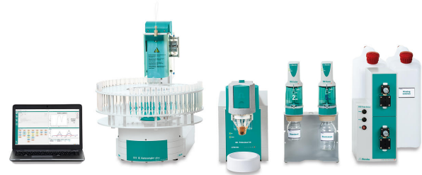
Abbildung 1. 884 Professional VA, vollautomatisch für die VA-Analyse
