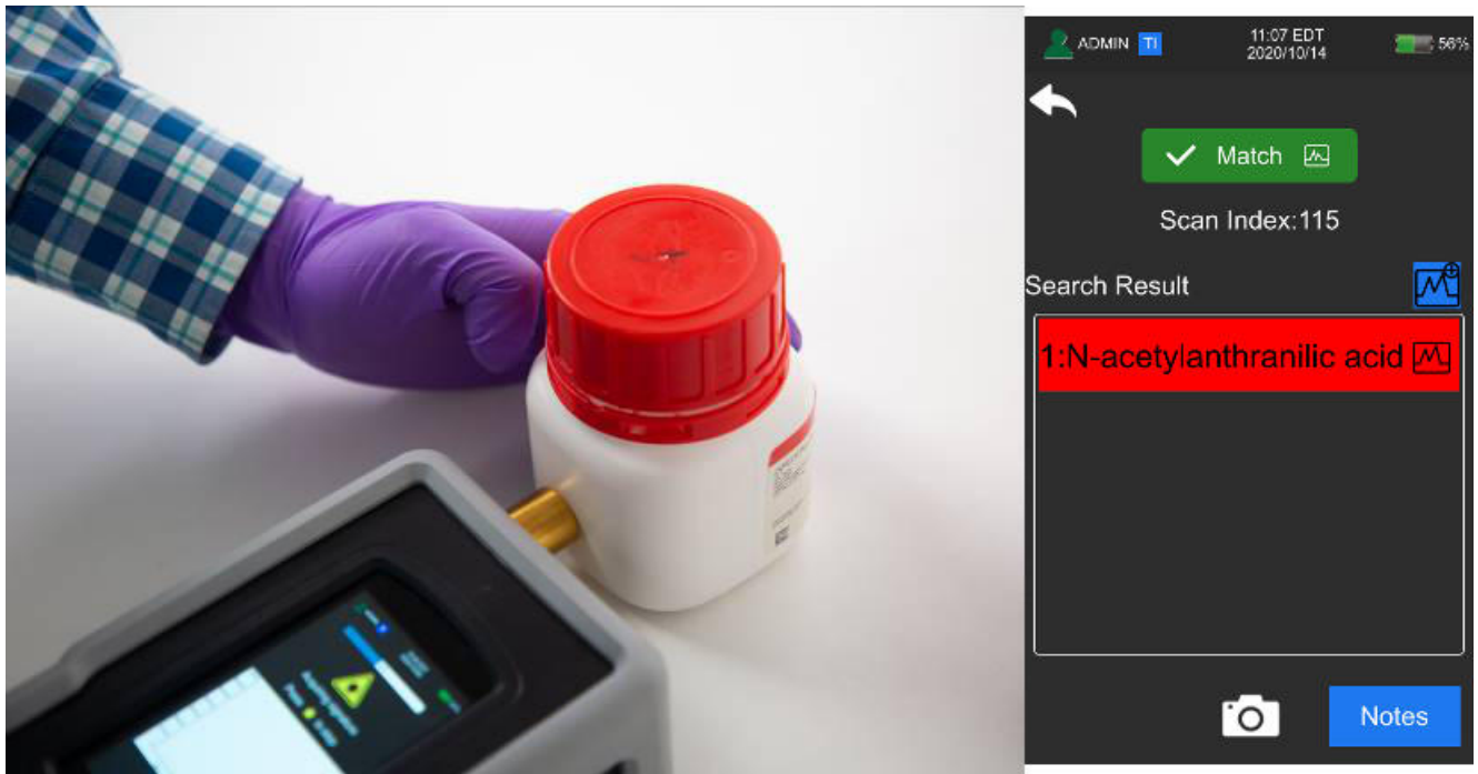
Abbildung 4 TacticID-1064 ST-Messung durch HDPE-Flasche und Übereinstimmungsergebnis für N-Acetylanthranilsäure
