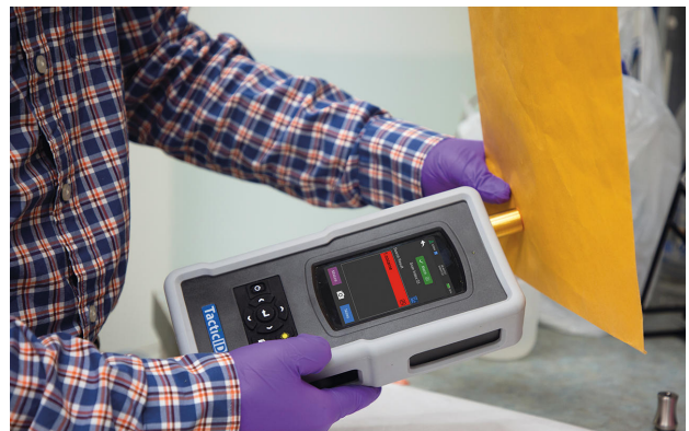
Abbildung 1 TactiD-1064 ST misst eine Probe durch einen Manila-Umschlag mit ST-Adapter
