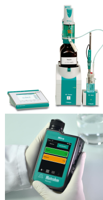
Abbildung 1. Zur gleichzeitigen Erfassung von pH- und Raman-Daten wurden der 907 Titrande (oben) und der MIRA XTR (unten) von Metrohm verwendet.
