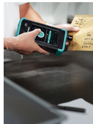
Abbildung 1. Das Auffinden von Schmuggelware - von Fentanyl bis Anthrax - in der Post ist ein sehr reales Problem. Die Fähigkeit von Raman, Papier zu durchleuchten, ist ein unschätzbare Vorteil.
