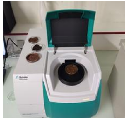
Abbildung 1. DS2500 Feststoffanalysator mit menschlichen Stuhlproben.
