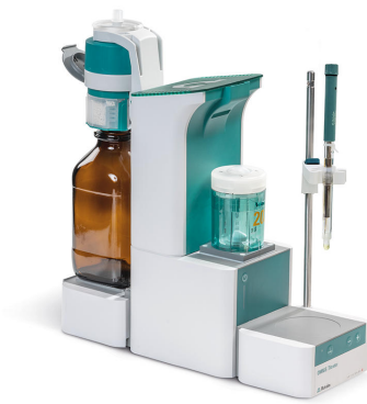
Abbildung 1. OMNIS Professional Titrator ausgestattet mit einer dUnitrode mit integriertem Pt1000.
