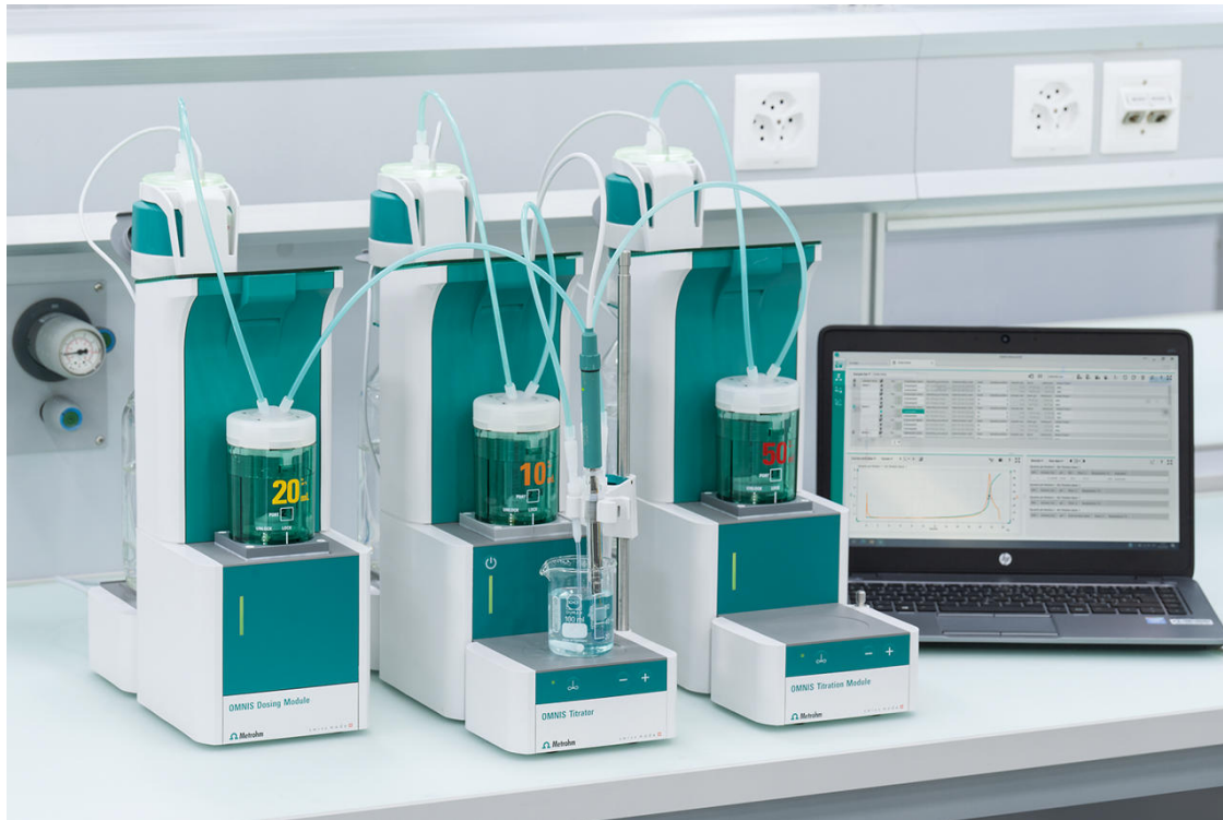
Abbildung 2 OMNIS Titrator ausgestattet mit einer dSolvotrode (pH-Elektrode) zur Bestimmung des Koffeingehaltes in nichtwässrigen Proben.
