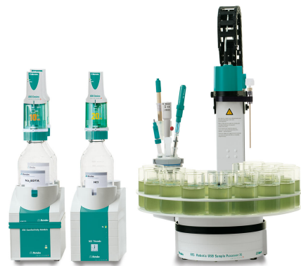
Abbildung 1. Beispielaufbau eines 815 Robotic USB Sample Processor XL mit einem externen Titriergefäß, einem 905 Titrandos und einem 856 Conductivity Module mit iAquatrode plus, kombinierter Ca-ISE, iAg-Titrode und 5-Ring-Leitfähigkeitsmesszelle für die Analyse von Leitungswasser.
