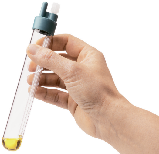
Figure 4. En utilisant des récipients de réaction jetables peu coûteux, le Rancimat 892 peut être utilisé efficacement, car les longues étapes de nettoyage ne sont plus nécessaires.
