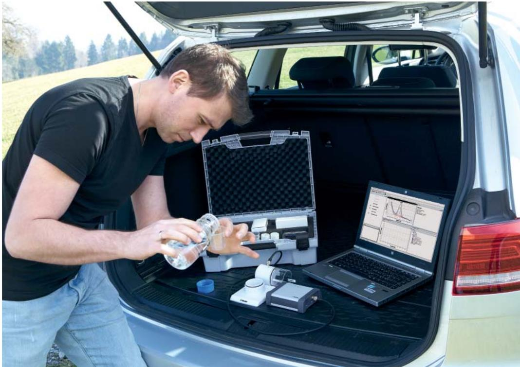
**Abbildung 6.** Der Portable VA Analyzer ermöglicht Messungen vor Ort und ermöglicht dadurch z. B. zuverlässige Speziationsanalysen von Arsen. Das Messgerät und das benötigte Zubehör passen in den dazugehörigen handlichen Transportkoffer.
