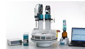
Die Tabletten werden automatisch mit Eluent versetzt und anschliessend mittels Homogenisierer zerkleinert. Die entstehende Suspension wird einige Minuten gerührt bevor man sie über Einwegfilter in PP-Probengefässe oder Vials filtriert. Die Steuerung der teilweise parallel ablaufenden Dosier-, Filtrier- und Probenwechsleroperationen erfolgt durch die Laborautomations- und Titrier-Software **tiamo™**.
