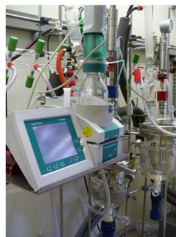
In einem Grossteil der Anwendungen werden Organomagnesium- und Organolithiumverbindungen sowie bisweilen auch Siliziumtetrachlorid an Carbonylverbindungen addiert. Dabei liegen die Dosierzeiten der Organometallverbindungen zwischen 0,1...2 mL/min; die Dosierzeiten betragen 2...5 Stunden.
