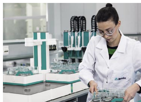
Figura 2: O novo OMNIS Sample Robot tem capacidade de até 175 amostras e permite a troca completa do rack de amostras sem interromper a operação.
