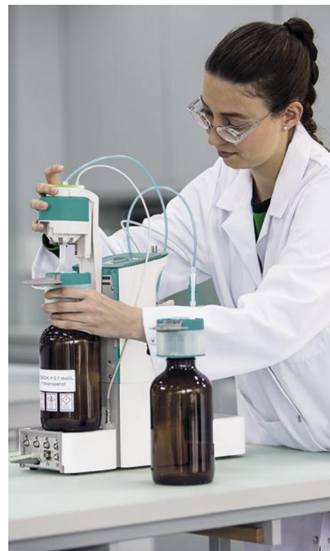
Figura 1: O Liquid Adapter dispensa a abertura de frascos para a troca de reagente e, por meio de comunicação por RFID, proporciona rastreabilidade da análise até o reagente.
