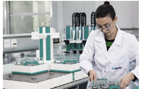
Figura 2: El nuevo robot de muestras OMNIS puede ser cargado con hasta 175 muestras y permite el intercambio de gradillas de muestras completas durante la operación del sistema.
