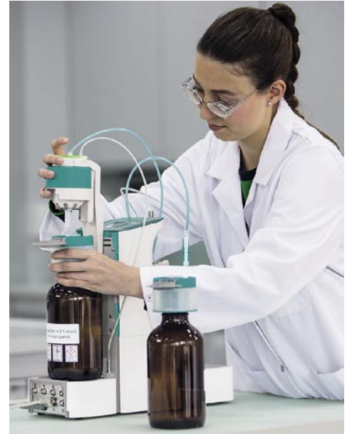
Figura 1: El “Liquid Adapter” conecta con los frascos de reactivos y así elimina la necesidad de abrirlos para el cambio de reactivos. La comunicación por RFID permite la trazabilidad del análisis hasta el reactivo.
