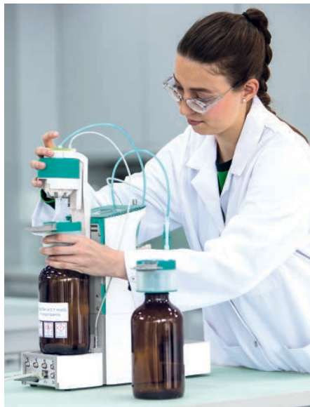
Abb. 1: Der Liquid Adapter erspart das Öffnen von Flaschen beim Reagenzwechsel und macht durch RFID-Kommunikation die Analyse rückführbar bis zum Reagenz.
