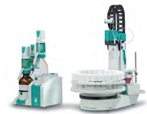
Figura 1. Sistema Mati13 para la determinación totalmente automática del índice de permanganato.
