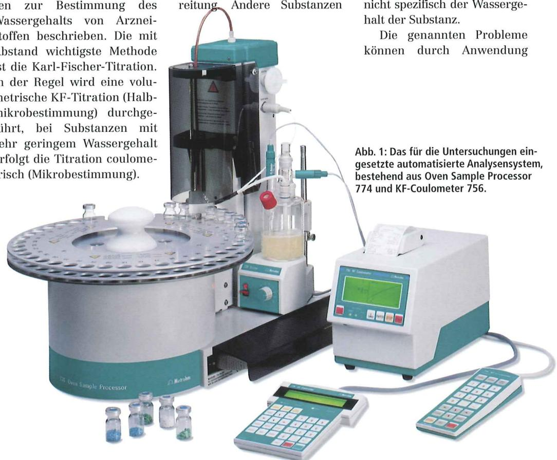
Abb. 1: Das für die Untersuchungen eingesetzte automatisierte Analysensystem, bestehend aus Oven Sample Processor 774 und KF-Coulometer 756.
