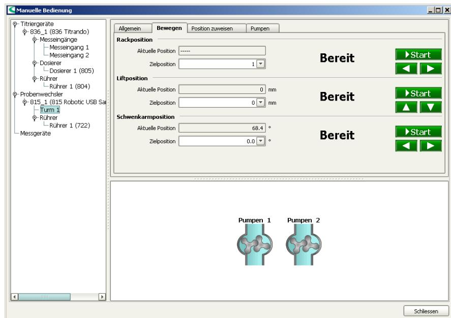
Im linken Teil des Fensters werden die angeschlossenen Steuergeräte mit ihren Peripheriegeräten aufgelistet. Im rechten Teil des Fensters werden die Funktionen des ausgewählten Gerätes angezeigt, in diesem Beispiel diejenigen des Turms eines 815 Robotic USB Sample Processors XL.
