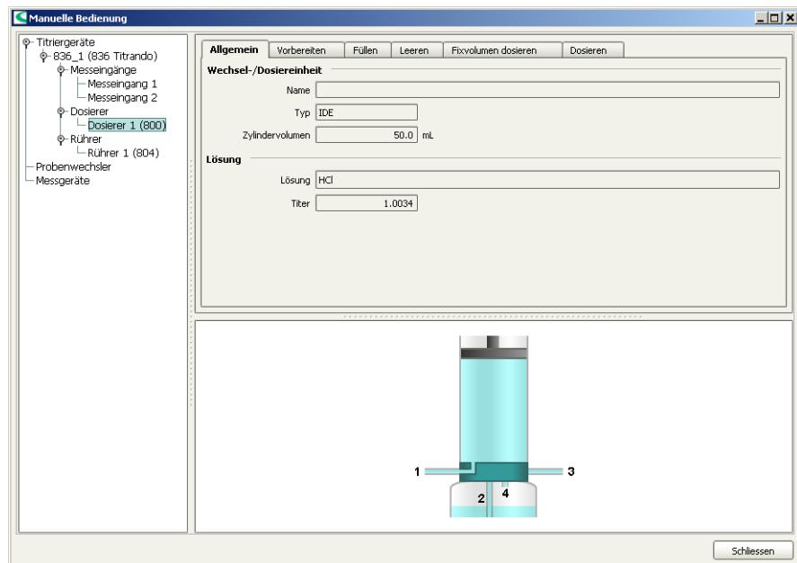
Im linken Teil des Fensters werden die angeschlossenen Steuergeräte mit ihren Peripheriegeräten aufgelistet. Im rechten Teil des Fensters werden die Funktionen des ausgewählten Gerätes angezeigt, in diesem Beispiel diejenigen eines Dosierers.
