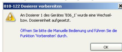
Mit der Funktion **Vorbereiten** werden alle Schläuche sowie der Zylinder gespült. Das Vorbereiten der Wechsel- bzw. Dosiereinheit wird in *Kapitel 2.3.1, Seite 27* beschrieben. Die Wechsel- bzw. Dosiereinheit muss zuerst konfiguriert werden.
