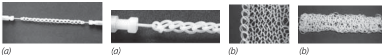
Abbildung E16: Geknoteter (a) bzw. gestrickter (b) Schlauchreaktor zur Minimierung der Dispersion bei gleichzeitig guter Durchmischung der Reaktionspartner. Die Ausschnittvergrößerung zeigt die Regelmässigkeit des Strickmusters.
