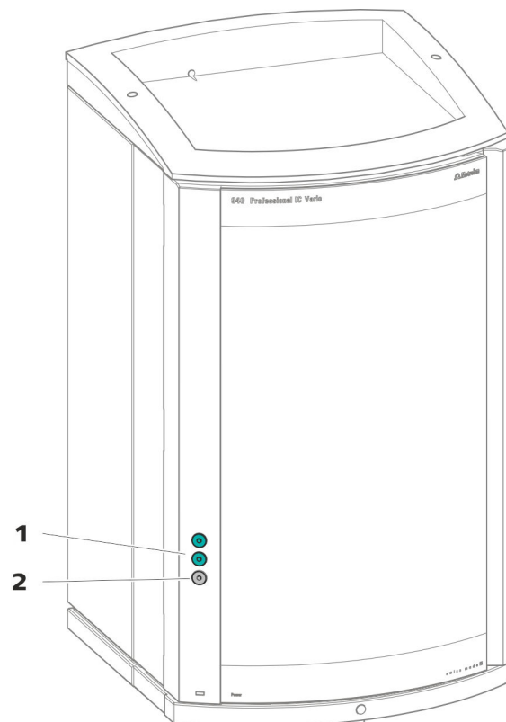
Abbildung 3 Durchführungen an der Tür
