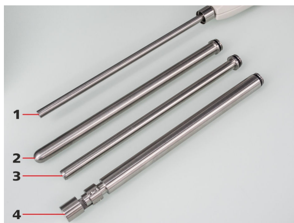
Figure 6 Sondes de mesure / manchon de protection
