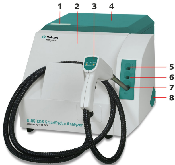
Figura 1 Parte anterior del aparato de medida
