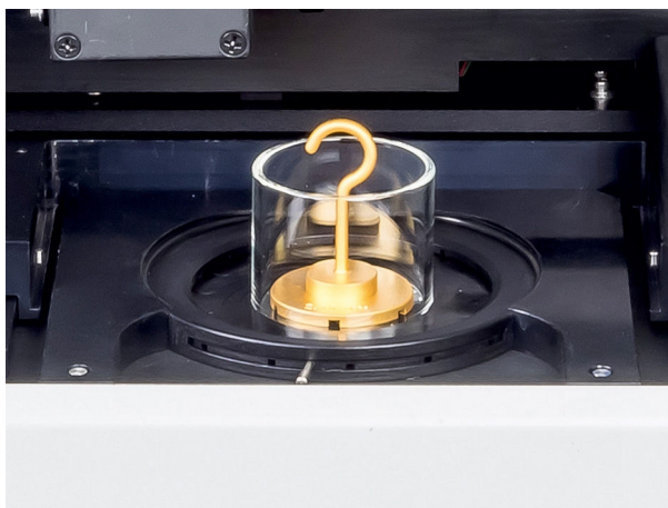
Abbildung 9 Transflexionsgefäß mit Gold- oder Edelstahl-Reflektor
