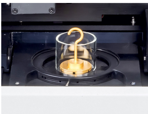
Figure 8 Récipient de transfexion avec réflecteur en or ou en acier inoxydable
