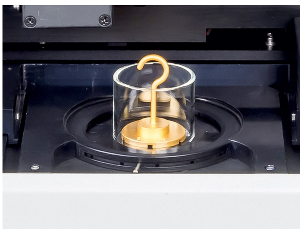
Figura 8 Recipiente de transflexión con reflector de oro o acero fino
