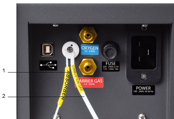
図12 Combustion Oven (TEI) - 出口
