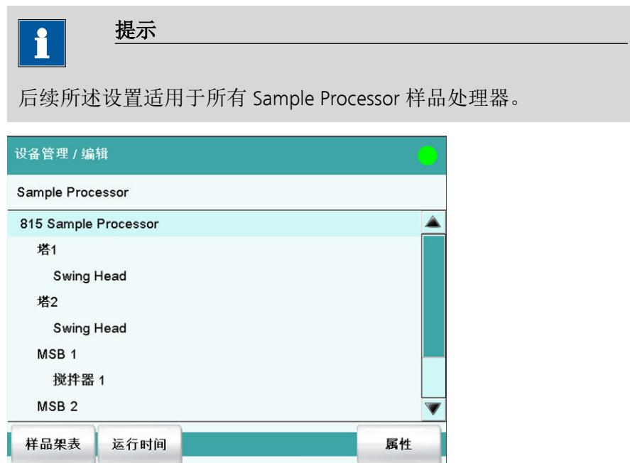
对话框显示带有单个塔（或多个塔）、MSB 接口并连接了外围设备（加液器、搅拌器、Remote Box）的 Sample Processor 样品处理器。如果未连接控制装置，则将直接打开控制装置的属性对话框（参见章节 11.5.1，第 85 页）。
