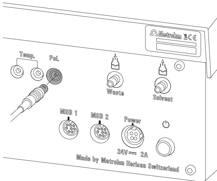
图6 连接极化电极
