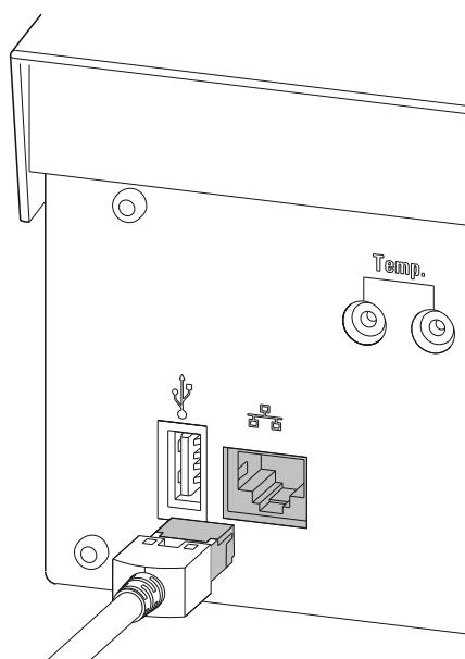
图8 将 Ti-Touch 连接到网络上
