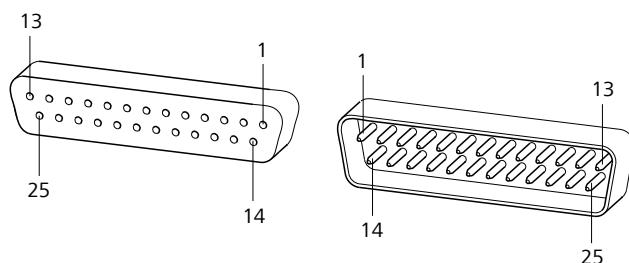
图 18 远程控制插口及插头的引线分配
