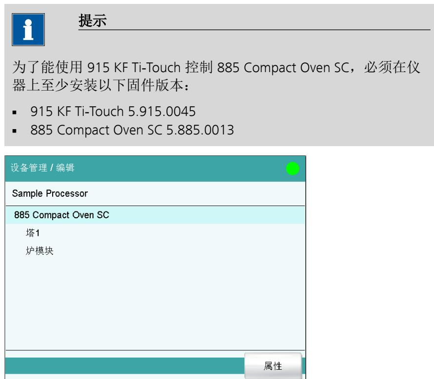
对话框显示了 885 Compact Oven SC 及其塔和炉模块。如果未连接控制装置，会直接显示控制装置的属性对话框（参见章节 11.7.1，第 99 页）。
