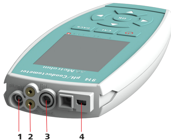
Figura 4 914 pH/Conductometer (analógico): conectores
