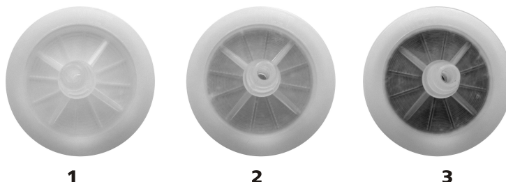
Rysunek 17 Stan filtra przeciwpyłowego
