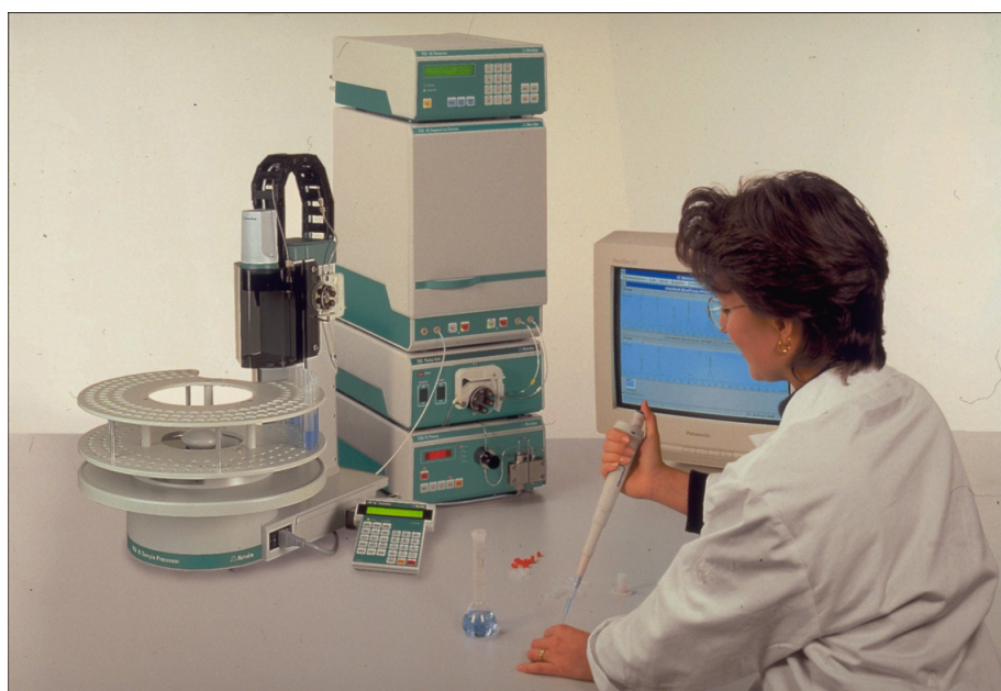
Fig. 1: Système CI avec Détecteur CI 732, Centre de séparation CI 733 et Passeur d'échantillons CI 766
