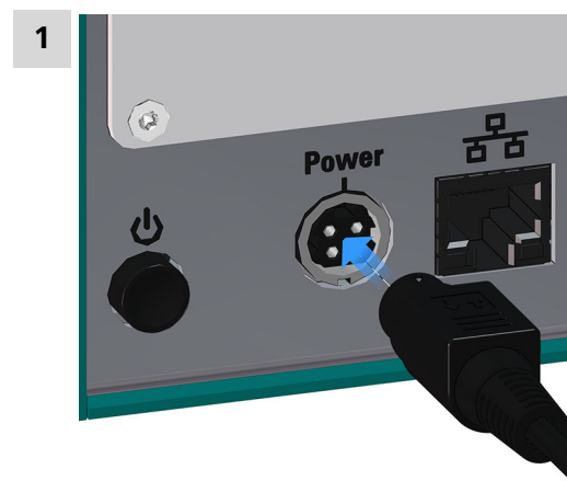
Figure 13 Face arrière de l'appareil – connecter un bloc d'alimentation
