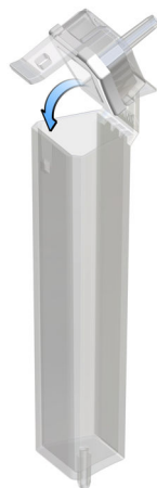
图 9 封闭涡形吸收器
