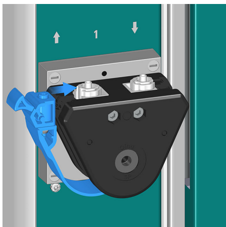
Figura 47 Montaje de la abrazadera de presión – Primer lado
