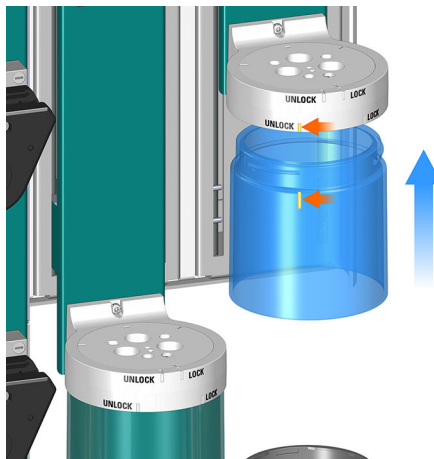
Figura 14 Colocación de la cubierta de seguridad
