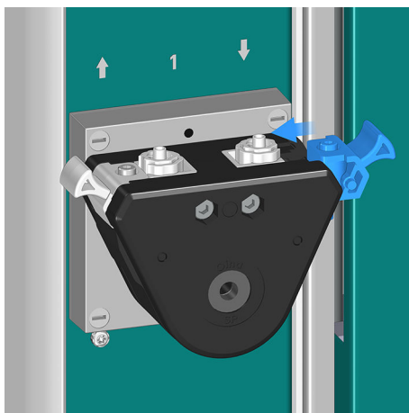
Figura 48 Montaje de la abrazadera de presión – Lado siguiente
