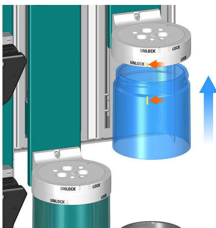
图 14 安放安全盖板
