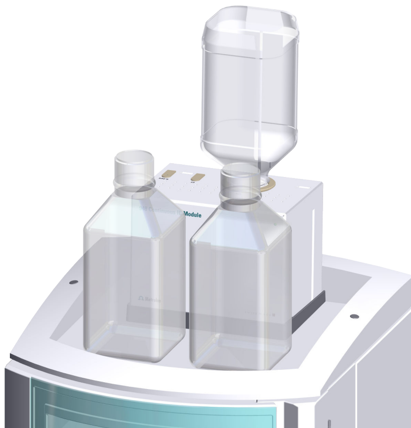
Abbildung 15 Flaschenhalter mit 948 Continuous IC Module und Flaschen
