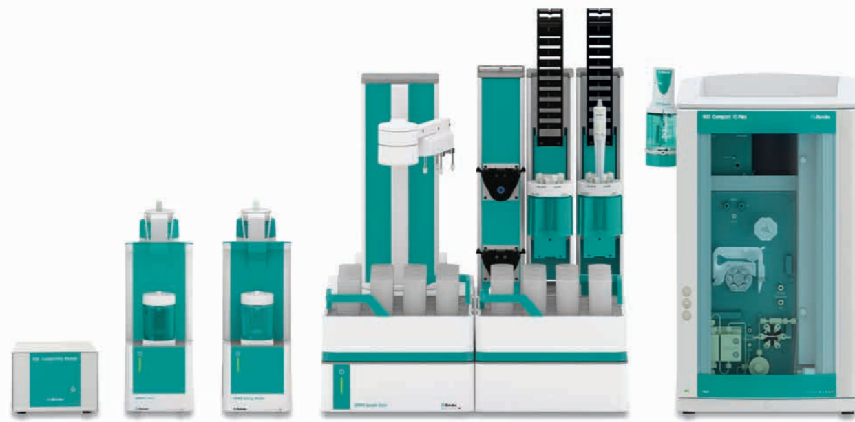
TitriC Flex I – das vollautomatische System zur direkten Messung von Temperatur, Leitfähigkeit und pH-Wert, der titrimetrischen Bestimmung von Calcium und Magnesium sowie der p- und m-Werte. Die Anionen werden gleichzeitig mittels Ionenchromatographie nach Durchlaufen der Inline-Ultrafiltration bestimmt.
