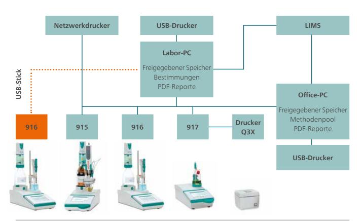
Integrieren Sie die Ti-Touch-Produktreihe in Ihr vernetztes Labor: automatischer Export von PDF-Reporten und Bestimmungsdateien in Ihr LIMS auf Ihrem PC im Labor oder Büro, Druck auf lokalen oder Netzwerkdruckern und Austausch von Titrationsmethoden über ein zentralisiertes Netzwerkverzeichnis. Sogar Daten von Geräten, die nicht an das Netzwerk angeschlossen sind, können über einen manuellen Export auf einen USB-Stick übertragen werden.
